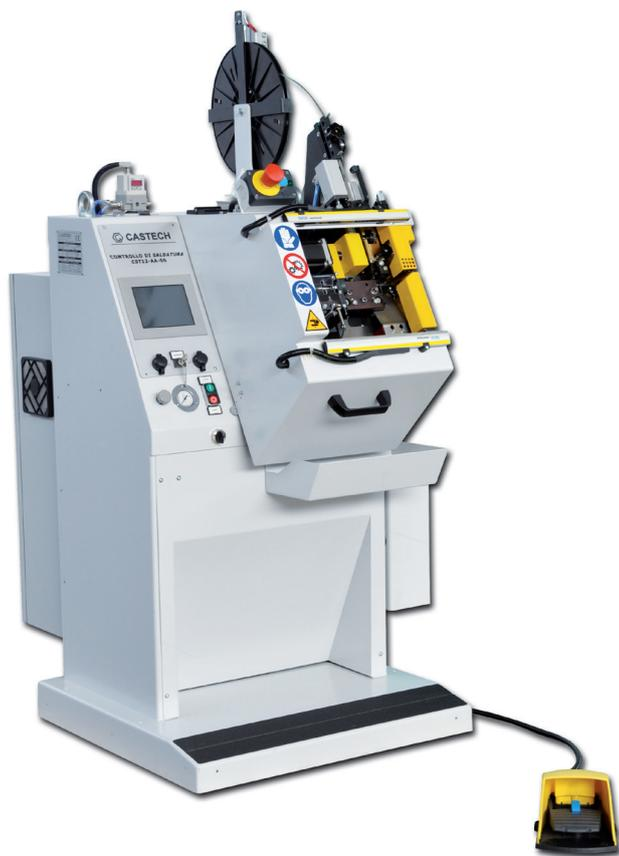
La Termograffatrice modello ESS6 è stata sviluppata per la connessione di fili smaltati e cavetti utilizzati nell'industria elettromeccanica per la costruzione di motori elettrici, trasformatori, bobine e altro.
